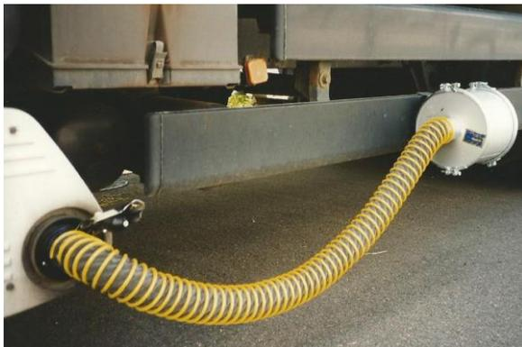
Bei der mobilen Ausführung für Lkw's **CTK MOBIL** schließt ein Abgas Schlauch an das Filtergehäuse an. Die Verbindung mit dem Auspuffende wird durch ein Schnellspannsystem hergestellt. Die Schnellspannsysteme wurden für unterschiedliche Auspuffformen und Durchmesser entwickelt.
