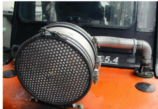
Die Filter **CTK FIX** für den Festeinbau werden mit zwei Haltern an einer geeigneten Stelle des Fahrzeugs montiert. Zur Anbindung an das Abgasrohr stehen Flexrohre und Auspuffschellen zur Verfügung.
