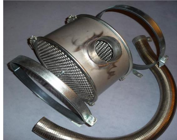
Beim DUO-Filter **CTK FIX** befindet sich der Abgaseintritt radial am Gehäusemantel. Das Filtergehäuse ist mit 2 Filterelementen bestückt. Damit können größere Motorleistungen abgedeckt werden bzw. erhöht sich die Kapazität zur Rußaufnahme.
