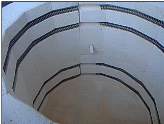
Einblick ins Innere des Regenerationsofens mit den Heizspiralen und dem Temperaturfühler
